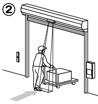
② シートが完全に開いた事を確認し通過してください。上限停止時間(工場出荷3秒)開いたまま待機します。
