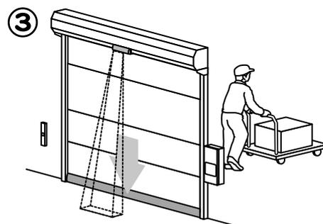
③ 起動センサー及び、光電管センサーが検知していなければ設定秒数後、自動で下降し全閉します。
